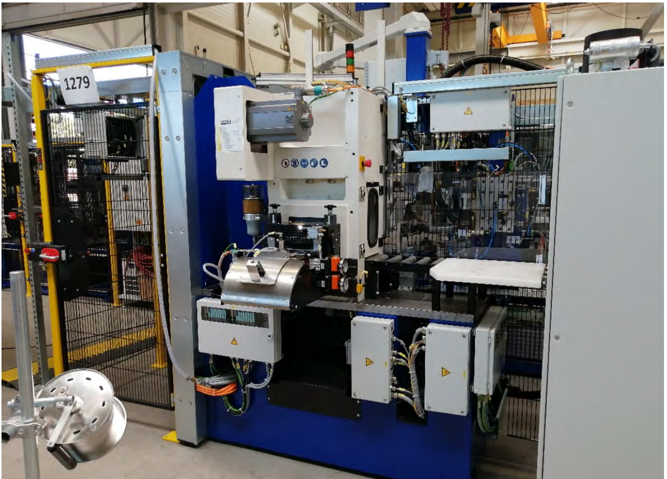
Stanzanlage zur Herstellung von Kupplungslamellen SEP 12 mit Bandanlage, Walzen-Vorschubgerät SWV 202, Rundschalttisch mit 6 Stationen, komplette Automatisierung für Beladen, Wenden und Entnehmen.
